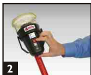
2 Appuyer sur le commutateur rouge pour activer. Le voyant vert s'allume. Un voyant qui clignote à intervalles lents indique un mode en VEILLE normal.
