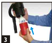
3 Remettre en place le bol et revisser vers le haut. Ajuster le bol jusqu'à ce que l'aérosol soit activé et dévisser légèrement.
